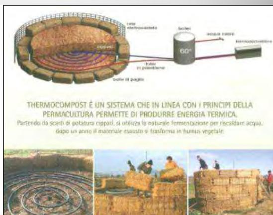
**THERMOCOMPOST È UN SISTEMA CHE IN LINEA CON I PRINCIPI DELLA PERMACULTURA PERMETTE DI PRODURRE ENERGIA TERMICA.**
